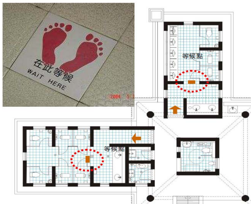
圖 2 標示等候線地磚之案例(二二八公園公廁)
